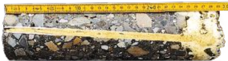
Der hier dargestellte Bohrkern zeigt links die Injektionslanze und rechts den mit dem URETEK Expansionsharz aufgefüllten Hohlraum.
