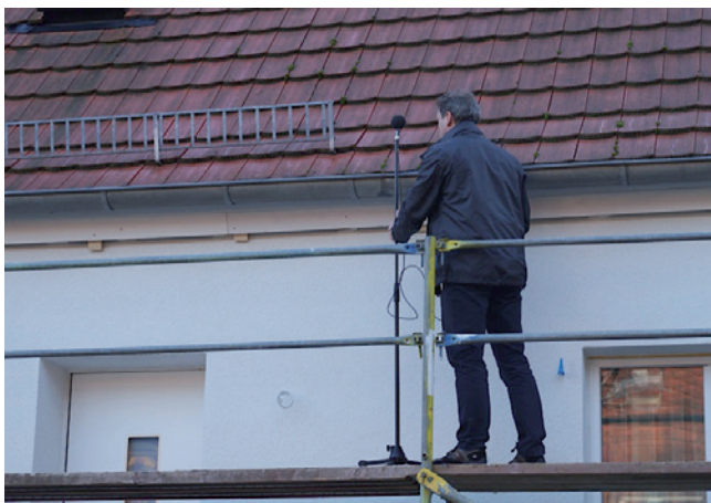
Auftreffen der Schallmessung am Gebäude
