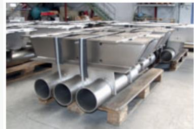
▲ Spanndrahtführungen für Brücken
