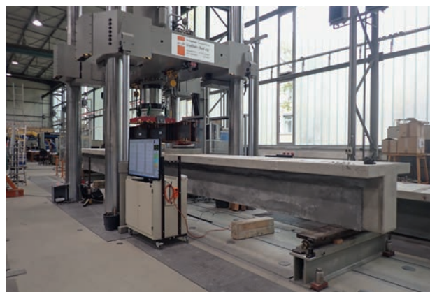
Bild 7 Großbauteilversuch im Rahmen der Zustimmung im Einzelfall Large-scale bending test for project-related approval
