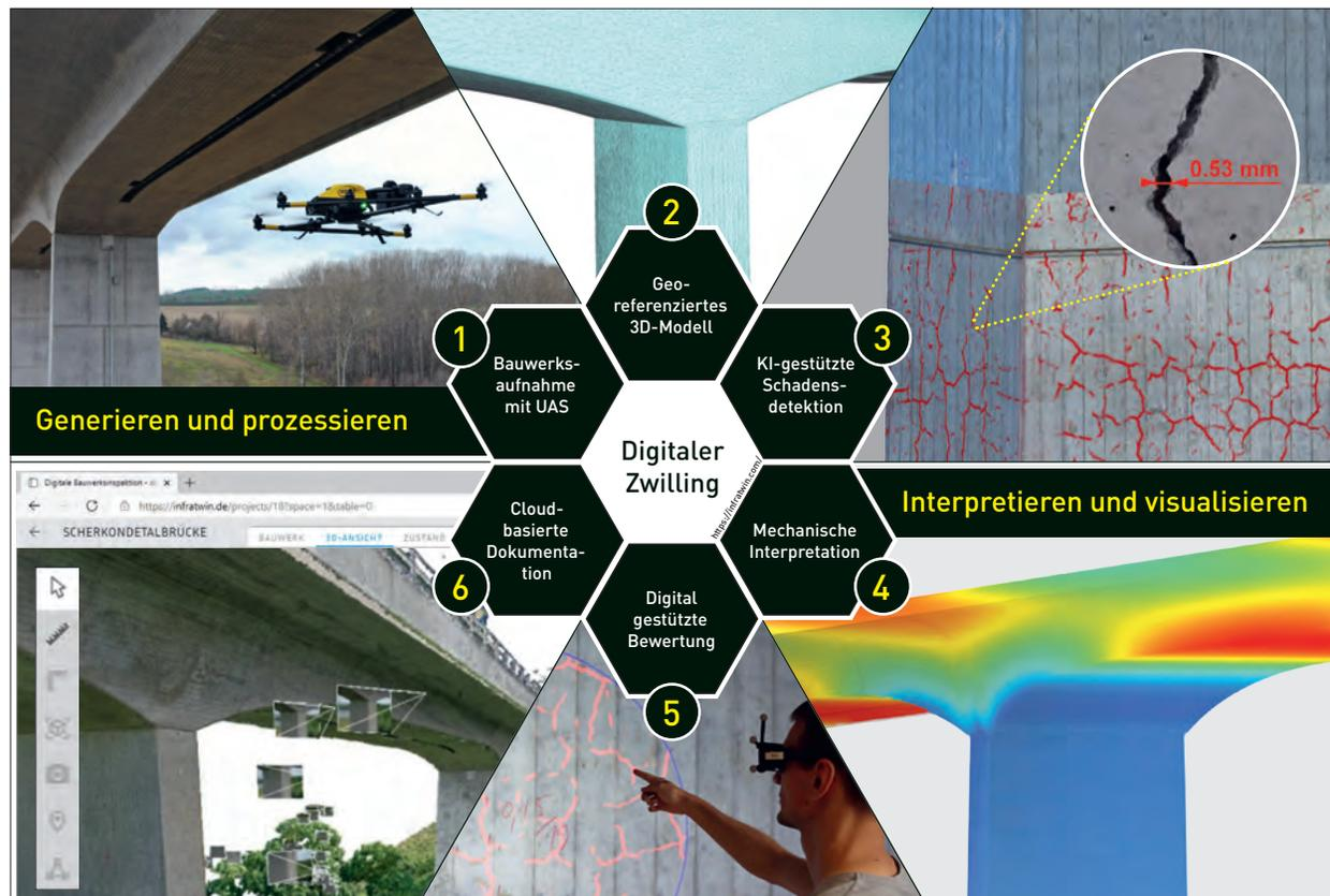
1 Ein Pilot befliegt das Bauwerk auf einer geplanten Route und erfasst fotografisch die relevanten Bauwerksteile. 2 Aus den Bilddaten werden die Geometrie und eine hochauflösende Oberflächentextur ermittelt. 3 Eine auf typische Bauwerksschäden
