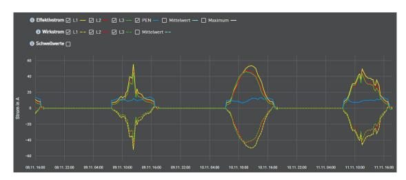
Beispiel: Eine PV-Anlage führt mit 77 kWp zu einer hohen PEN-Belastung.
