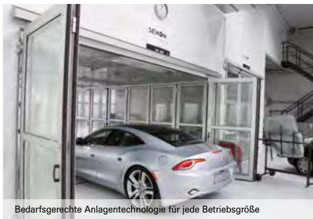
XXL-Kabinen mit voll-laminarer Luftführung für Top-Qualität
