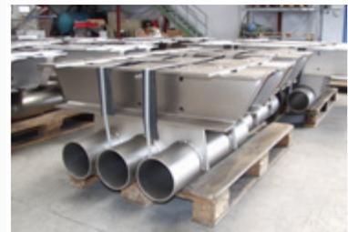
▲ Spanndrahtführungen für Brücken
