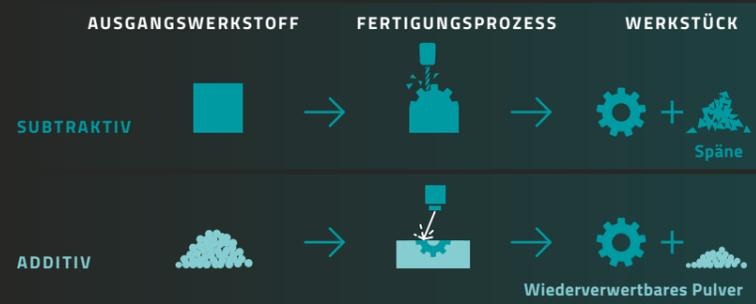
Additive Manufacturing (AM) oder Additive Fertigung bietet vollkommen neue Möglichkeiten. Beim L-PBF Verfahren (Laser Powder Bed Fusion) baut sich das Werkstück Schicht für Schicht auf. Der Laser schmilzt dabei das zu verarbeitende Material in Pulverform auf. Dadurch wächst das Bauteil sinnbildlich im 3D-Effekt in die Höhe.
